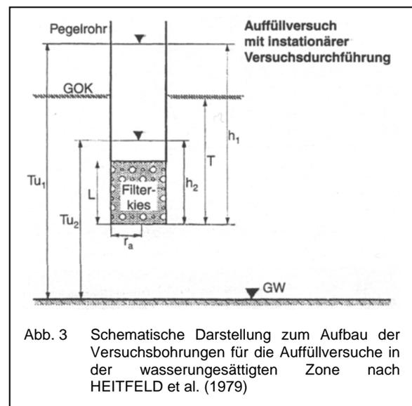
Abb. 3 Schematische Darstellung zum Aufbau der Versuchsbohrungen für die Auffüllversuche in der wasserungesättigten Zone nach HEITFELD et al. (1979)
